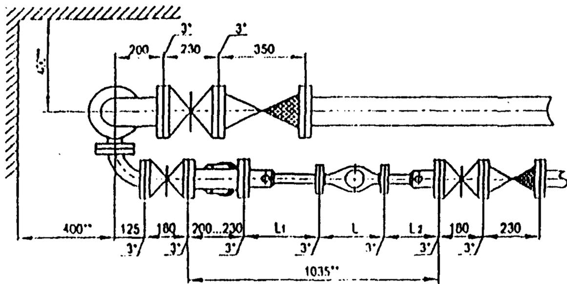
Установка счетчиков  $\text{Dy} 20 \dots 50 \text{ мм}$  на хозяйственно-питьевой линии с раздельной системой хозяйственно-питьевого и противопожарного водопроводов на вводе диаметром 100 мм.
